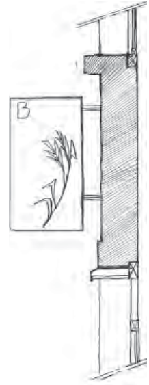
Enseignes en drapeau positionnées sous l'appui de la baie du premier étage (1)
