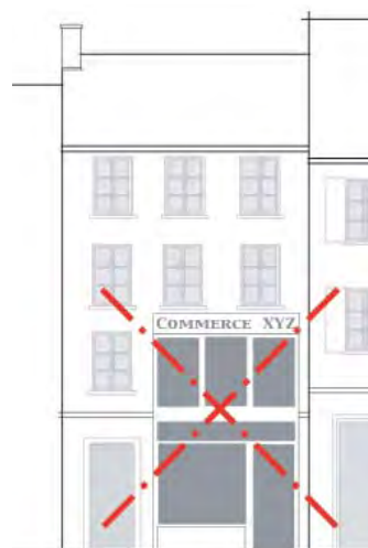
La composition des devantures commerciales doit respecter l'espace imparti au rez-de-chaussée
